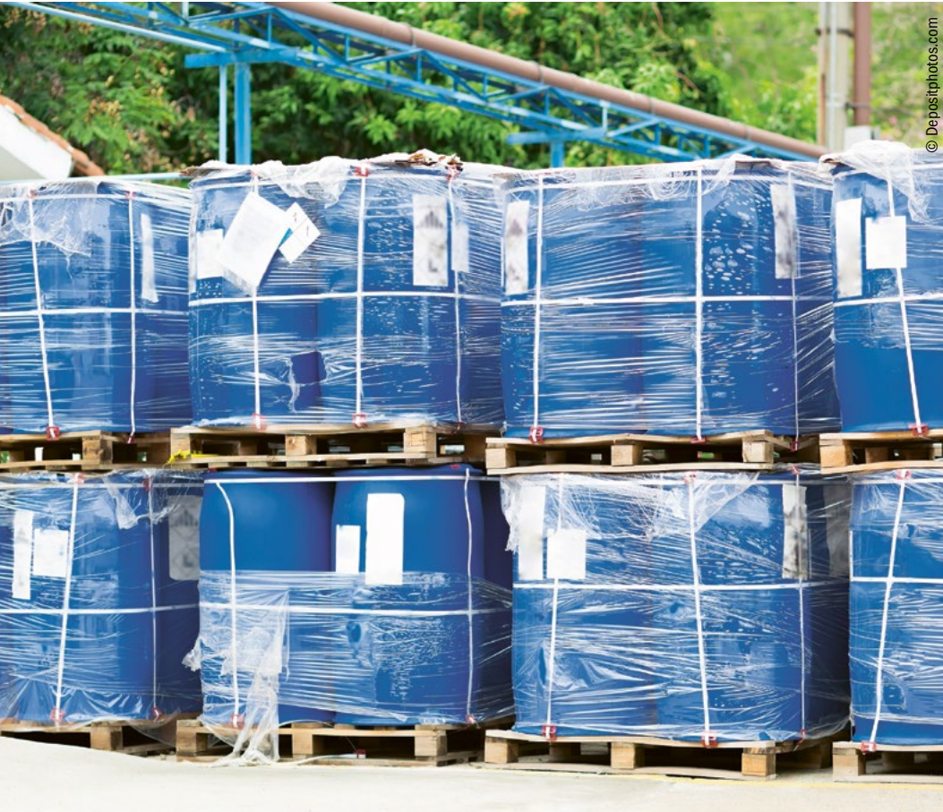
Leere, ungereinigte Verpackungen können wie gefüllte Gebinde transportiert werden. Notwendig ist dabei die Kennzeichnung mit Gefahrzettel und UN-Nummer des letzten Füllguts.
